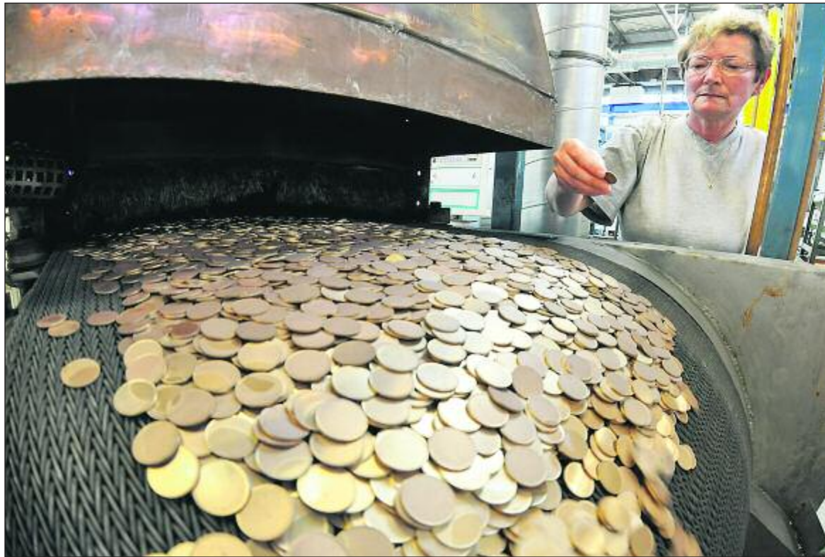
Sonja Gietzelt prüft an der Wärmebehandlungsanlage die Qualität der Münzrohlinge.
